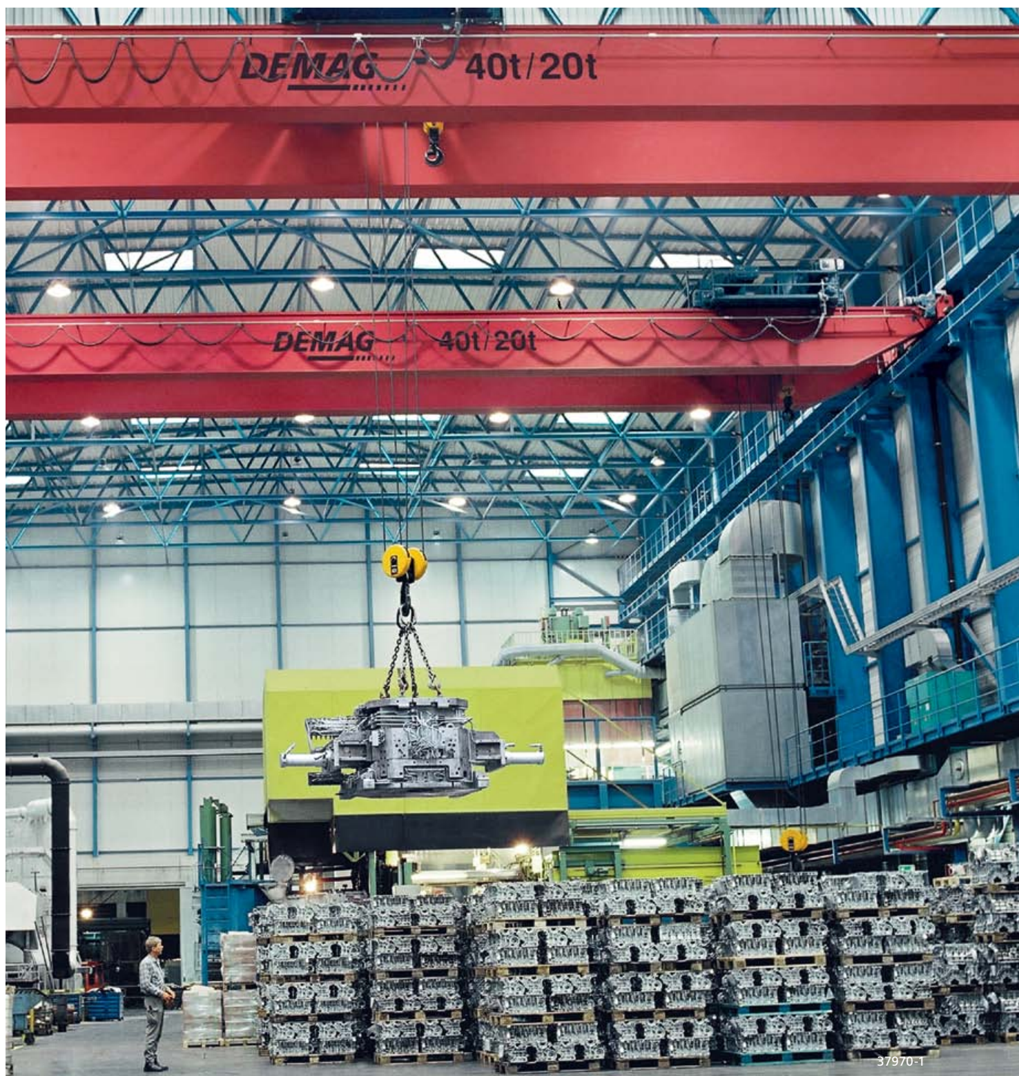
Kaksipalkkinosturi tandemvaunuilla moottorilohkojen kuljettamiseen ja kääntämiseen
