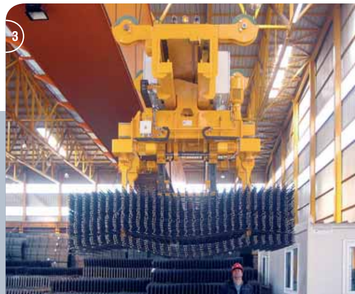
3-4 Elektromotorischer Baustahlmattengreifer, innen greifend, mit Drehwerk und Seilrollenaufhängung, mit längs und quer verstellbarer Greifweitenvoreinstellung und drehbaren Greiferfüßen, mit elektromotorischer Innenhöhenverstellung für unterschiedliche Mattenstapelhöhen.
