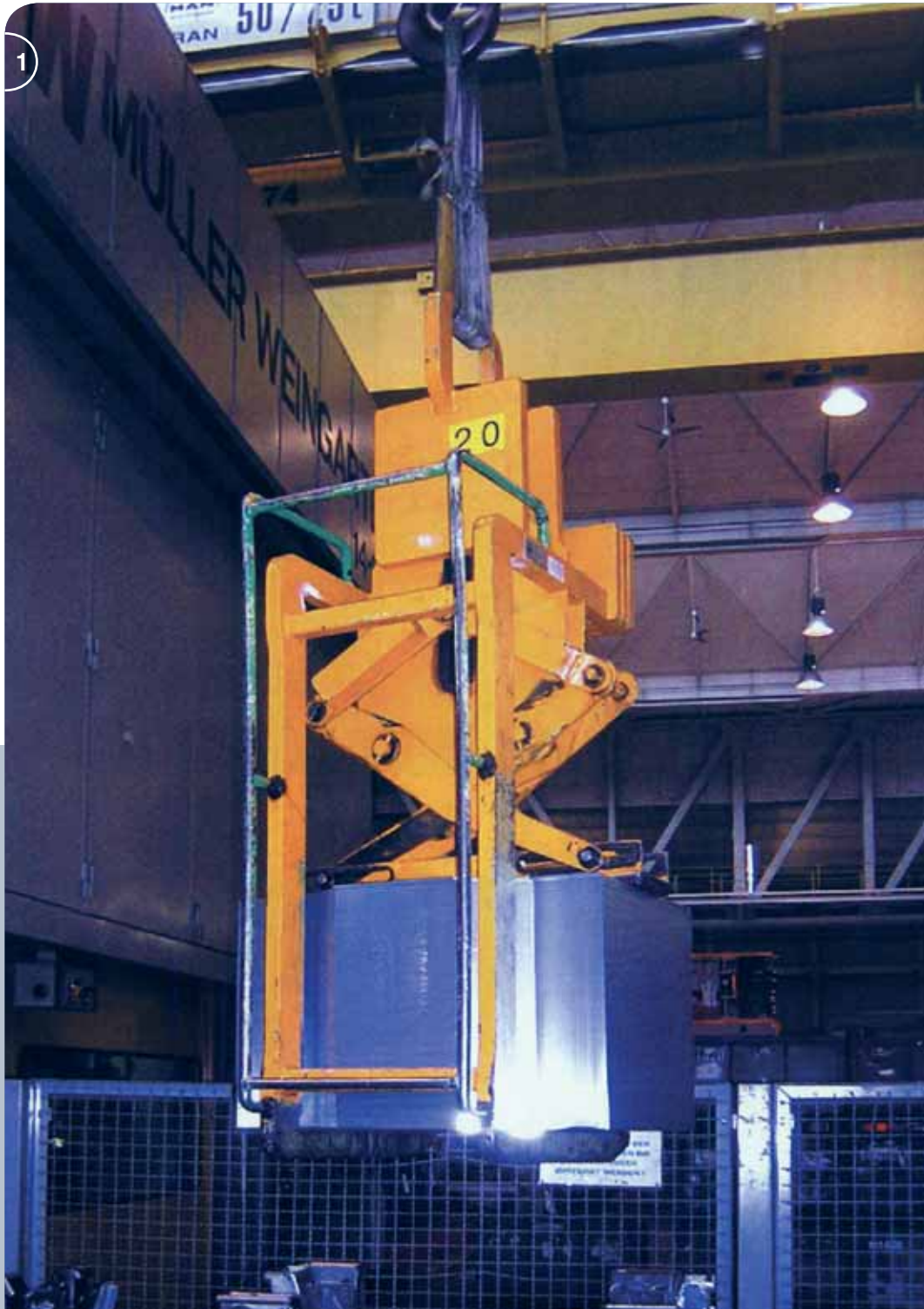
1 Platinenladegabel mit mechanischer Niederhaltefunktion. Board lifts with mechanical hold-down function.
