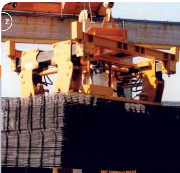
1 Elektrohydraulischer Baustahlmattengreifer, innen greifend. Electrohydraulic structural steel mesh grab, internal grab.
