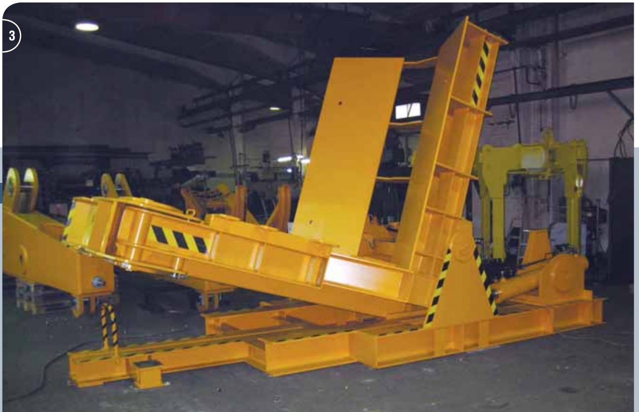
1-8 Elektrohydraulischer Kipptisch mit ausklappbaren Auslegern für besonders große zylindrische Lasten (hier: Turmsegmente für Windenergieanlagen) mit sehr unterschiedlichen Durchmessern. Electro-Hydraulic Tilting Table. With hinged side arms for extremely large loads (towers for wind turbines with varying diameters)
