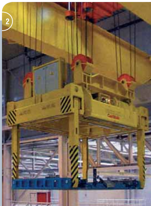
1-3 Elektromotorischer Werkzeuggreifer für die Automobilindustrie. Electromotive tool grabs for the automotive industry.
