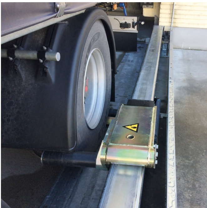
Kyt kentälaitte tekee lukitusvarrelle mahdolliseksi mitata renkaan koko ja nousta täyteen korkeuteen.
