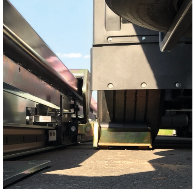
Roiskeläppien suojarampit estävät roiskeläppiä tarttumasta renkaan ja lukitusvarren väliin.
