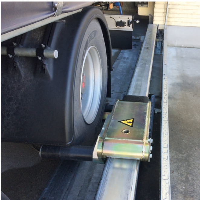
Kytentäilaite tekee lukitusvarrelle mahdolliseksi mitata renkaan koko ja nousta täyteen korkeuteen.
