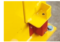
Turvalukitus (magneettikytkin- ja salpajärjestelmä).
