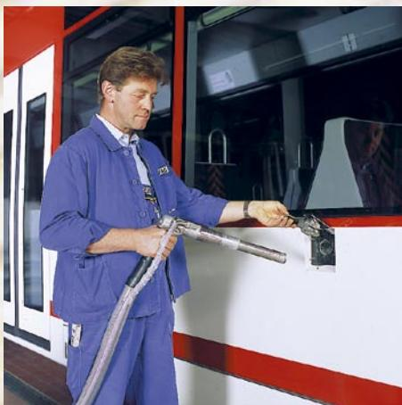
Füllventil mit integrierter Staubabsaugung
